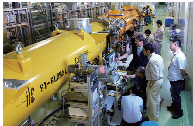
図10 / STF 超伝導RF試験施設では、ILCの最重要技術である超伝導加速技術の開発研究が行われている。写真は加速器の構成要素を世界から持ち寄った試験の様子
