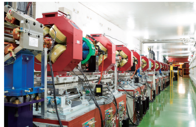
図11 / ATF 先端加速器試験施設(ATF)はILC実現に必要となる「ナノビームの生成、制御」技術の開発研究が行われている世界唯一の試験加速器。写真は最終収束系ビームラインATF-2
