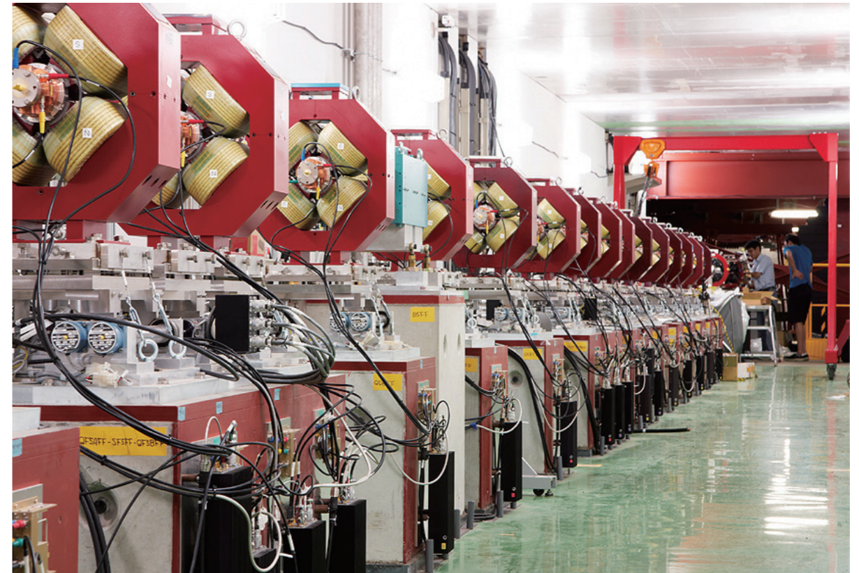
図23 / ATF2最終収束ビームライン。多くの磁石群、フィードバックシステムによって、最終収束点でのビームを安定に収束する
