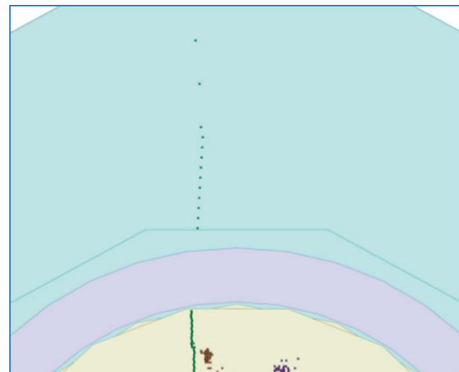
図36/ ミュオン測定器におけるミュオンの軌跡
