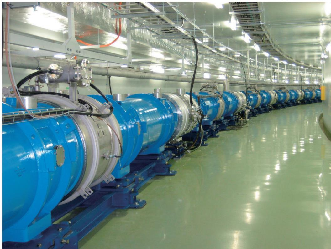
図6 / J-PARCのニュートリノ実験用ビームラインの超伝導磁石
