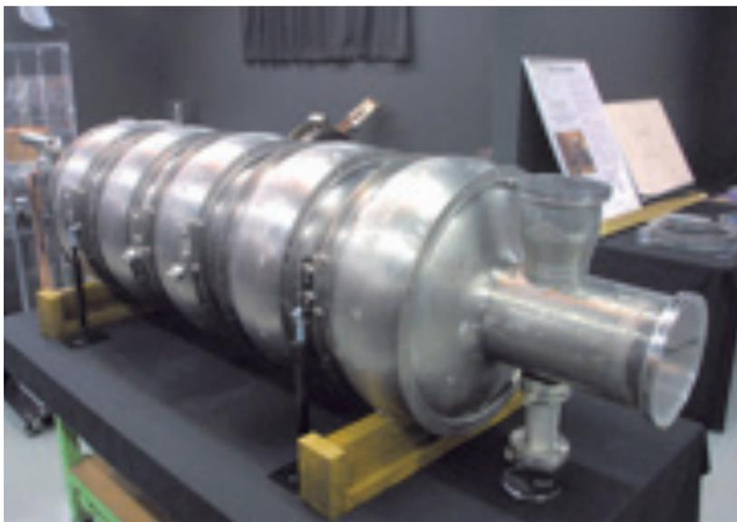
図4 / トリスタン加速器用五連超伝導加速空洞 (三菱重工製)
