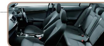
自動車のインストルメントパネルやドア、シートなどのプラスチック製内装部品の多くは製造過程で放射線が照射されています。ドアやシートの緩衝材、エアコンの断熱材などには「発泡プラスチック」が使われています。型に入れたプラスチック基材の外から放射線を当てて外形を固め、加熱処理で内部に発泡を作ります。車両の軽量化や、燃費の向上に役立っています
